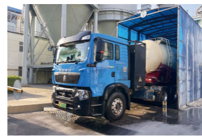
国泰发电设置车辆清洗装置进行除尘
