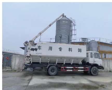
散装饲料车养殖场料塔投料
