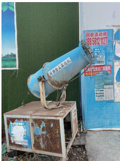
設置於工地各處的降塵裝置
