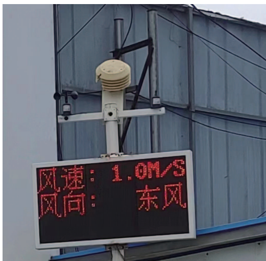
設置於工地的空氣質素監測系統
