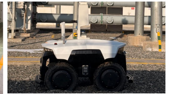
轮式室外机器人巡检汇集站设备
