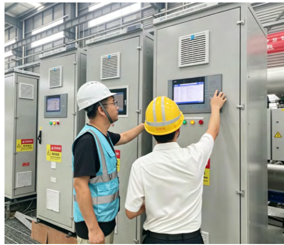
中电普瑞开展沙特中南柔直工程换流阀水冷控制系统生产过程质量监督
