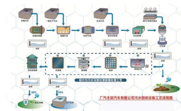
廣汽豐田污水回收設備工藝流程圖
