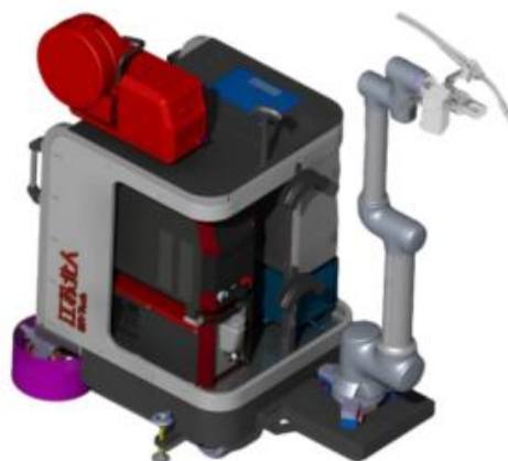
可移动车载智能焊接机器人
