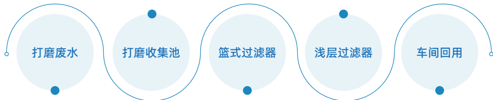
打磨废水回用项目工艺流程
