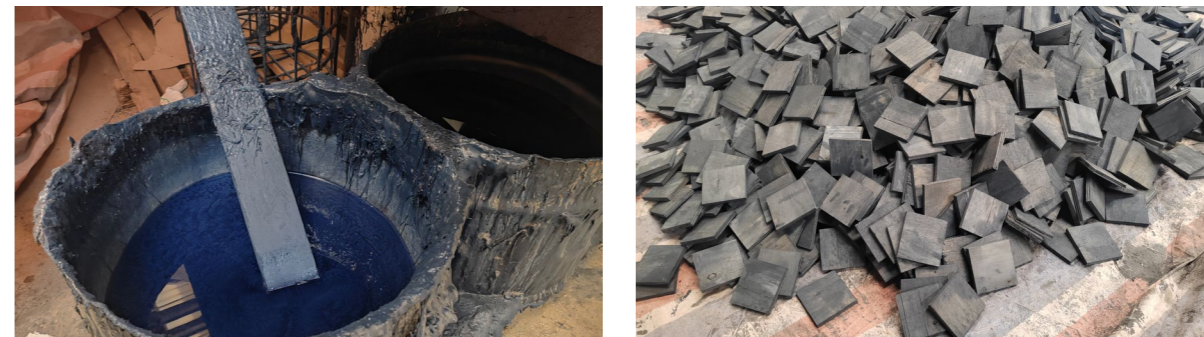
浸泡后的底板及废油漆再利用
