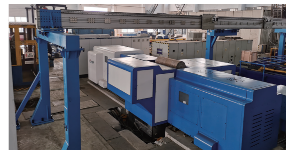
兆瓦级高温超导感应加热装置在 山东南山铝业铝挤压生产线示范应用
