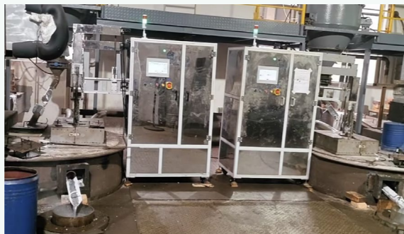
自動出鋰設備
