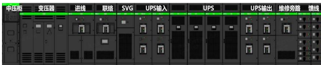
图：算力中心一体化电力模组
