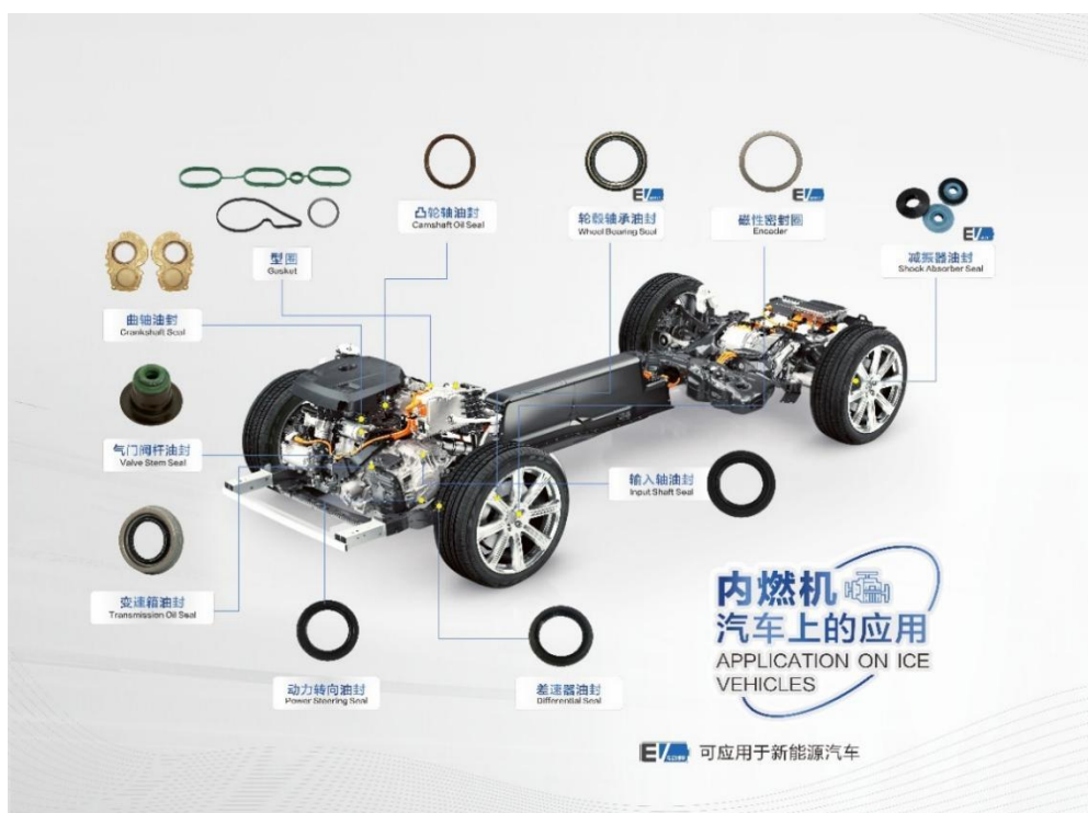
公司代表性产品在燃油车中的位置示意图
