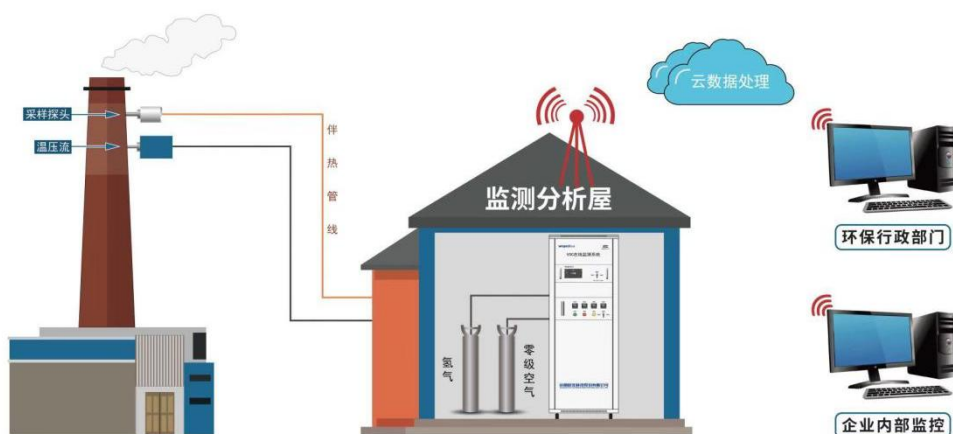
VOCs 在线监测系统工作示意图
