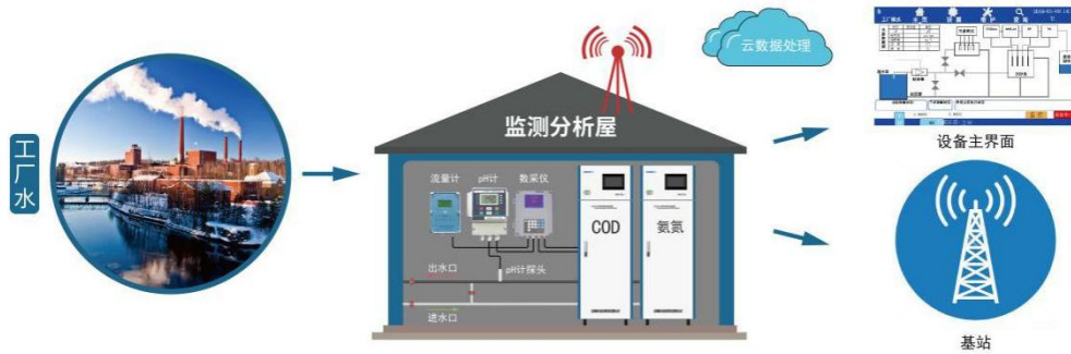
环境水质在线监测仪工作示意图
