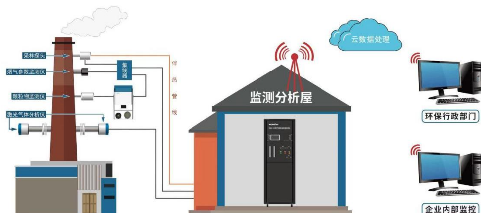
烟气排放连续监测系统工作示意图
