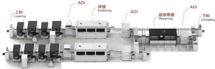
图：零缺陷焊接检测制造系统示意图
