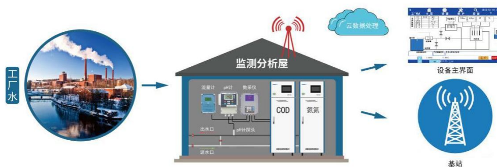
环境水质在线监测仪工作示意图
