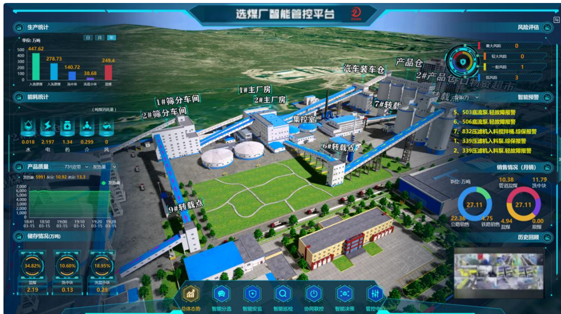
图 3-15 智能化选煤厂管控系统
