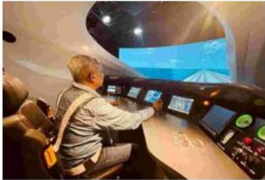
印尼雅万高铁高速动车组全功能仿真模拟驾驶培训设备
