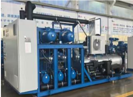
CO2 制冷压缩机组
