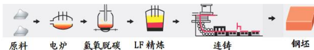
图 5-2：炼钢工艺流程图
