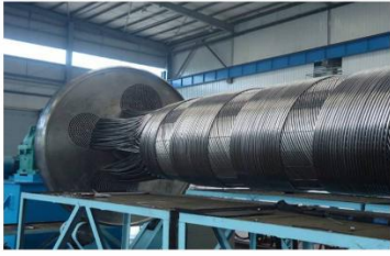
多股流缠绕管式换热器
