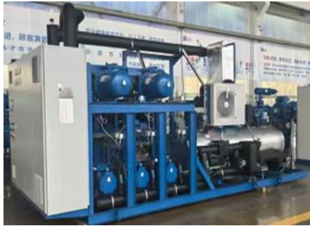
CO2 制冷压缩机组
