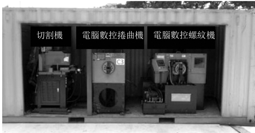
位於車間的三種機械鋼筋並接機
