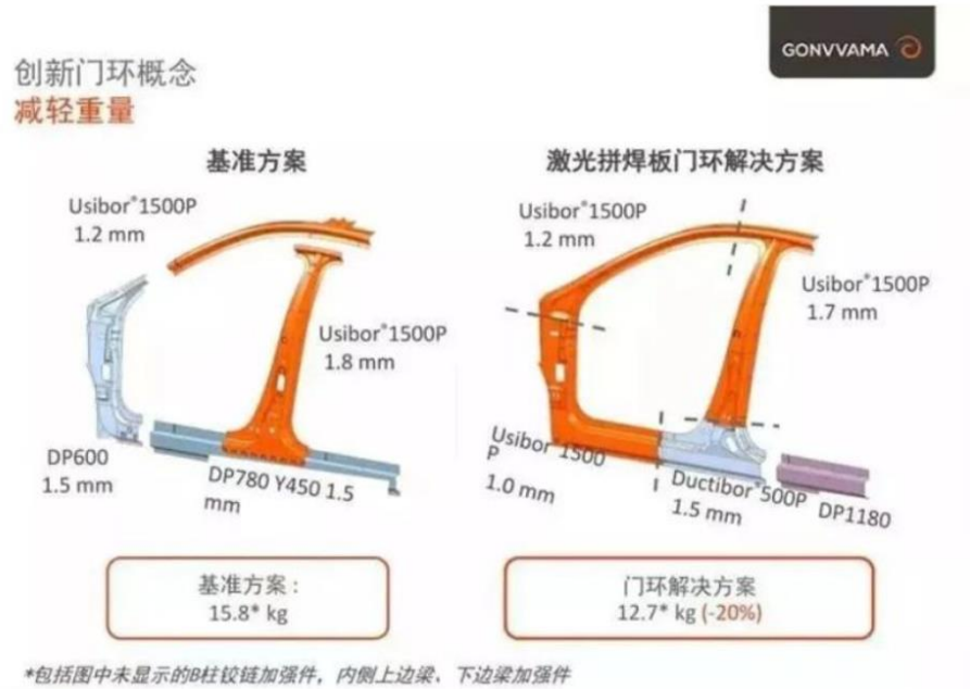
图2: 一体式冲压门环4合1方案
