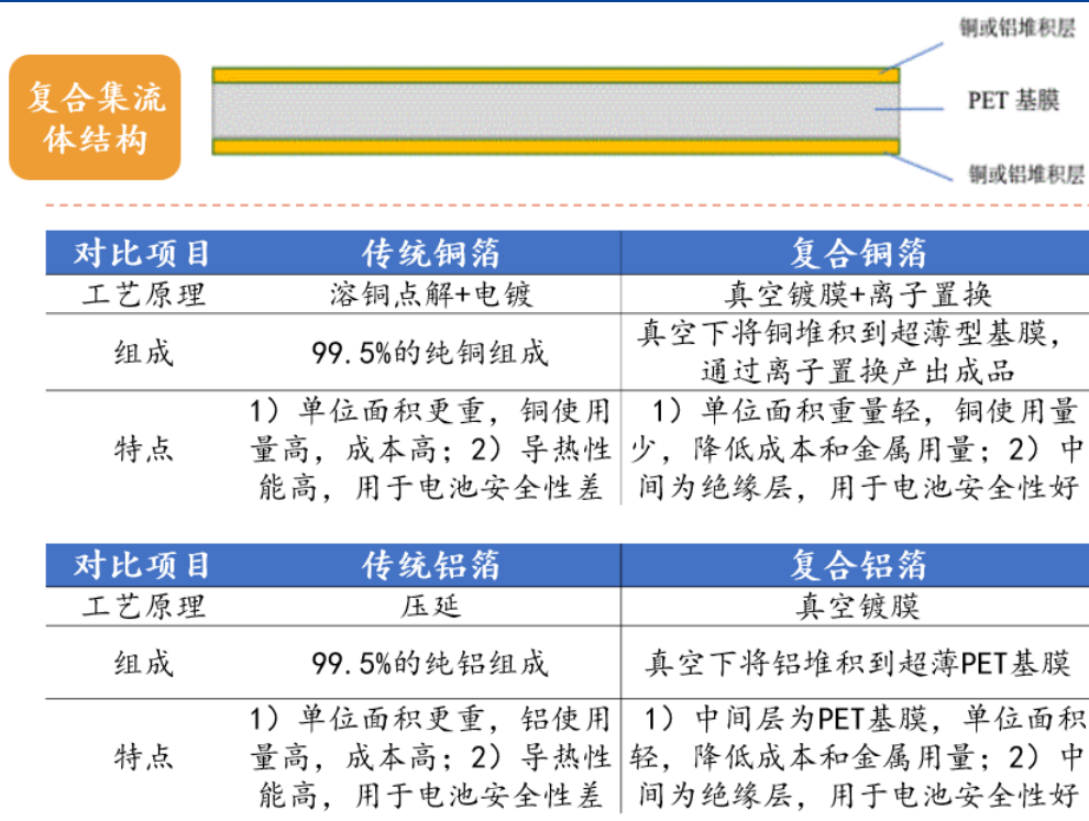
图表 8：复合集流体结构情况介绍
