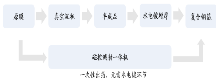
图表 62 洪田科技复合铜箔制备方案
