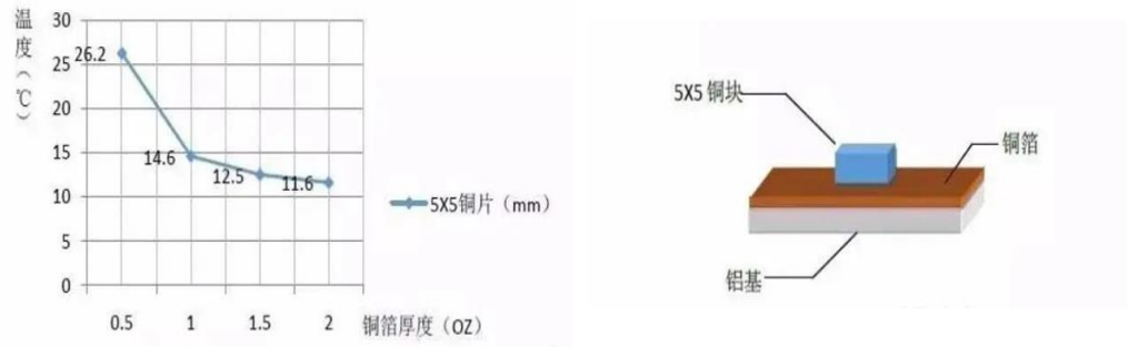
图表 54 导电铜箔厚度与导热之间的关系
