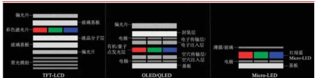
图17: 相比于其他显示技术, Micro LED 结构简单
