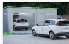
宁德时代evogo换电站
