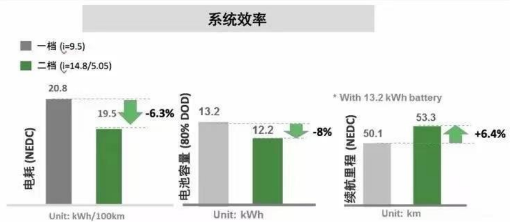
图24：二挡变速器电耗低、电池容量小，但续航里程更高
