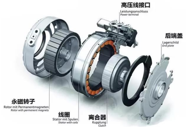
图14 永磁同步电机构造
