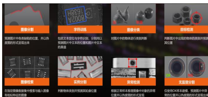
图8：海康机器人的高性能深度学习算法提供图像分割、分类、异常检测等算法模块
