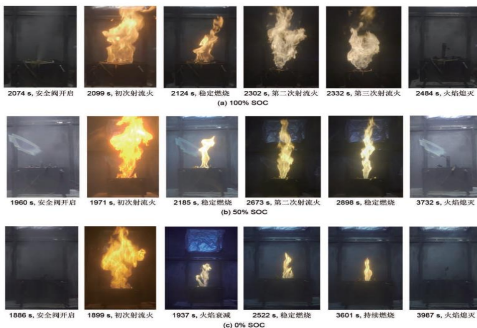
图7：228 Ah 的磷酸铁锂电池，100%SOC 状态下热失控产生三次射流火
