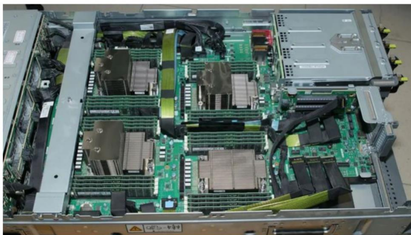
图 63：华为 Atlas 800 训练服务器内部结构图
