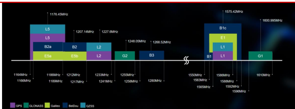
图 36 UM960 支持北斗、GPS、Galileo、GLONASS 和 QZSS 导航系统，适配多频点
