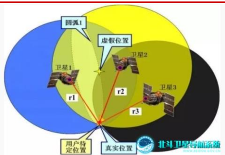
图 24 北斗“三球交汇”定位原理示意图
