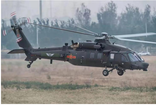
图22：直 20 是我国自主研发 10 吨级中型多用途直升机
