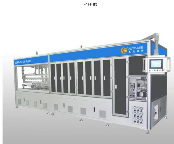
多主栅电池片自动串焊机GPV-DZ-A20
