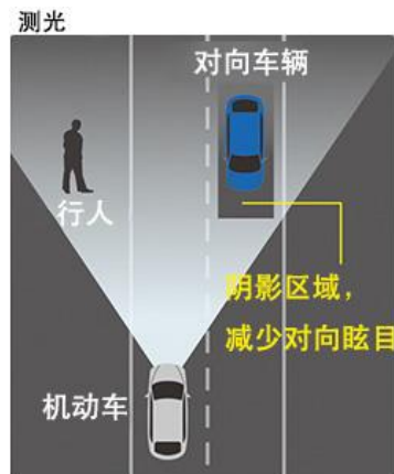
图表：ADB工作原理示意图
