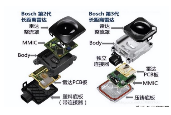
图35: 博世毫米波雷达结构
