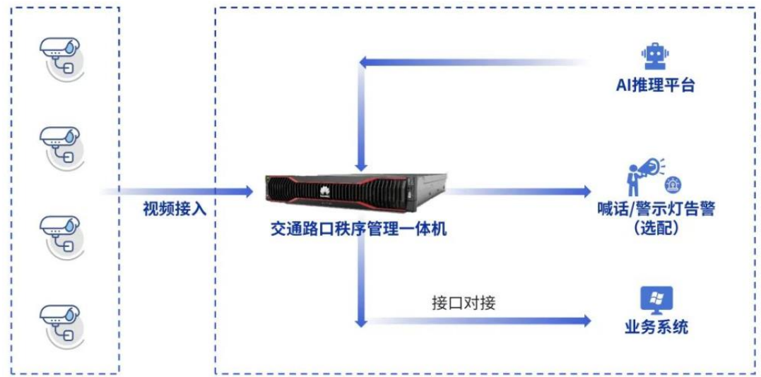
图表50: 交通路口秩序管理一体机应用流程
