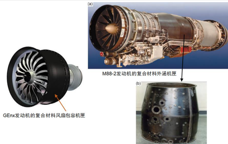
图 54：风扇机匣和外涵机匣开始采用复合材料
