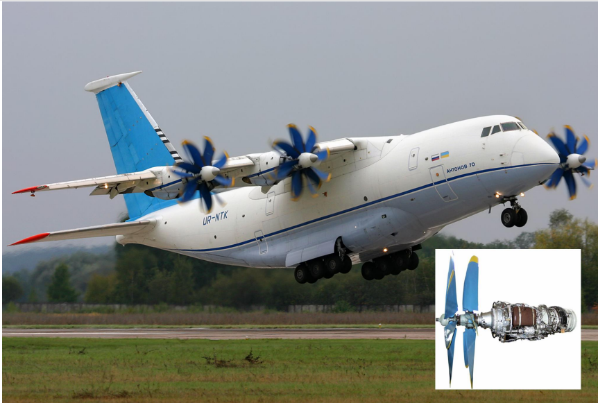
图 30：采用桨扇发动机的运输机安-70 及其桨扇发动机 D-27
