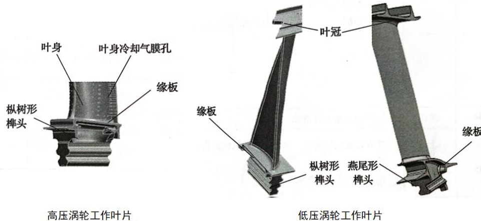
图 61：涡轮工作叶片
