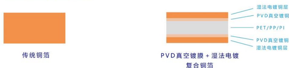
铜箔/复合铜箔断层示意图
