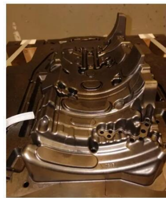
图34 Exco 3D 打印 V8 发动机缸体模具
