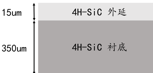
图6： 4H-SiC 衬底和外延示意图
