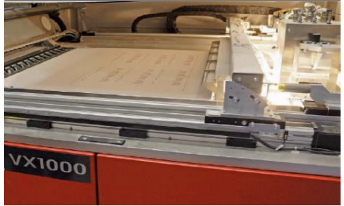
图9：砂型 3D 打印技术使用特质打印机
