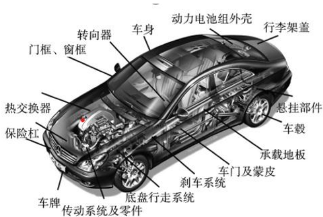
图 21：新能源汽车结构件可用铝合金的部位
