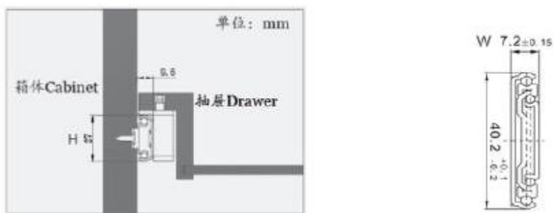
图15：家电滑轨以高度分类（图左），服务器滑轨以厚度分类（图右）
