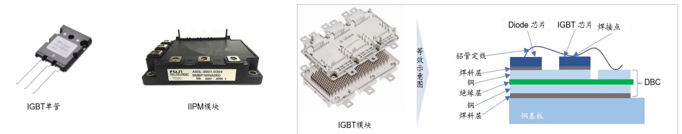
图表 4: IGBT 实物及 IGBT 单管、模块和 IPM 性能比较
