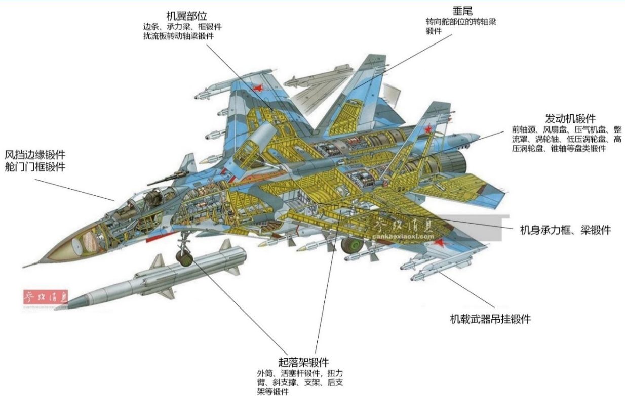
图表 36：锻件在飞机机身中的应用部位
