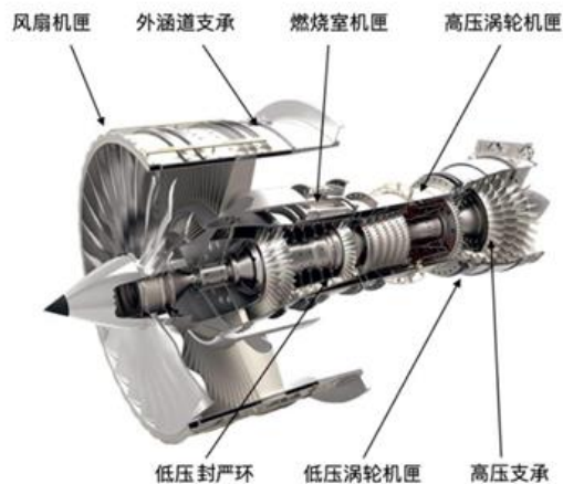
图表 43: 锻造件在航空发动机中的应用部位
