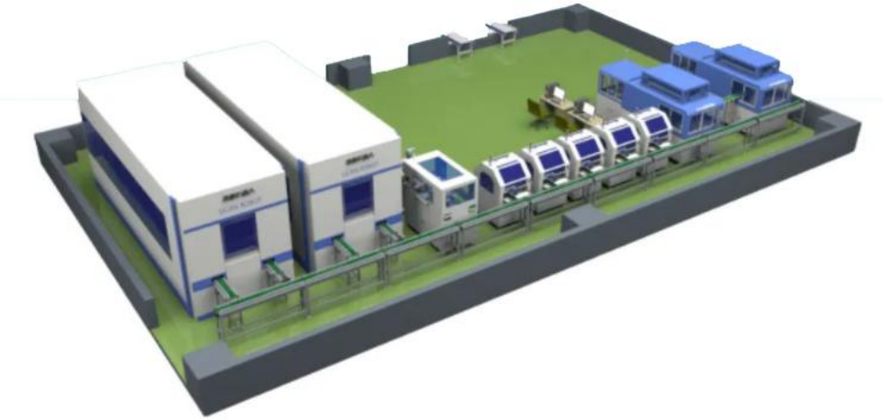
图 16：鼎泰高科智能钻针仓储系统图示
