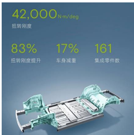
图表31 小鹏汽车前后一体式铝压铸车身
